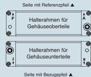
Werden mehrere identische MIXO-Steckverbinder eingesetzt, so sind Codierbolzen zu empfehlen, um Fehlsteckungen zu verhindern. (Serie CR..CX)
