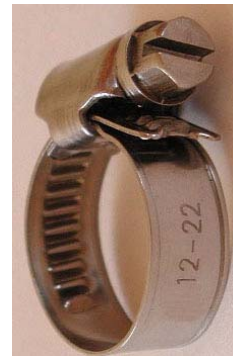
W2 - páska i domek nerez ocel, galvanizovaný šroubek (ekvi. ČSN17...), šířka pásku 9 mm
