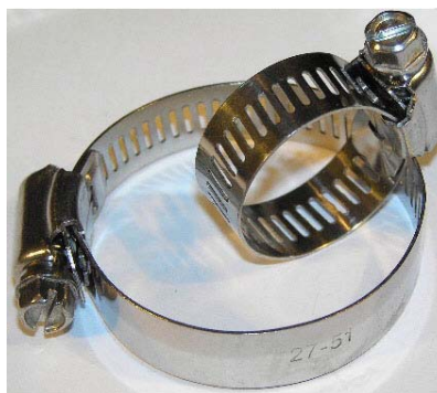
W2 - páska i domek nerez ocel, galvanizovaný šroubek (ekvi. ČSN17...), šířka pásku 9 mm
