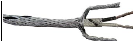
Kompenzační kabel, 2 x 0,75 mm 2 , lanko, typ J, FeCuNi, izolace vodičů ze skelných vláken, plášť drátěný oplet, do 400°C, vnější ø 4,7mm
