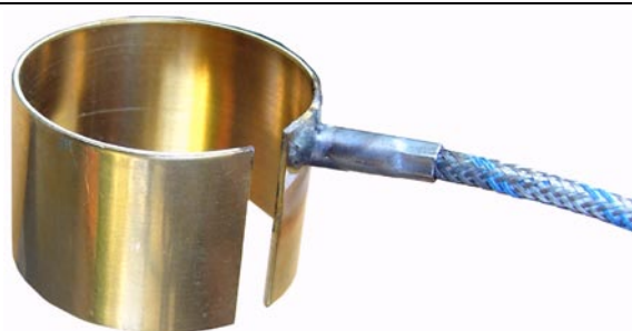
Termočlánek TF2015, který se vkládá mezi topné těleso DH200, DH400, DH600 nebo KH200 a trysku
