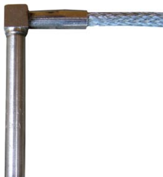
Úhlová topná patrona s navařenou kostkou Wü a fixační trubičkou, v které je upevněn ocelový opleť MS
